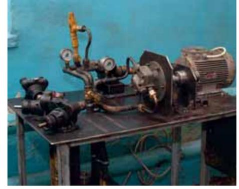
Стенд для проверки топливных насосов
